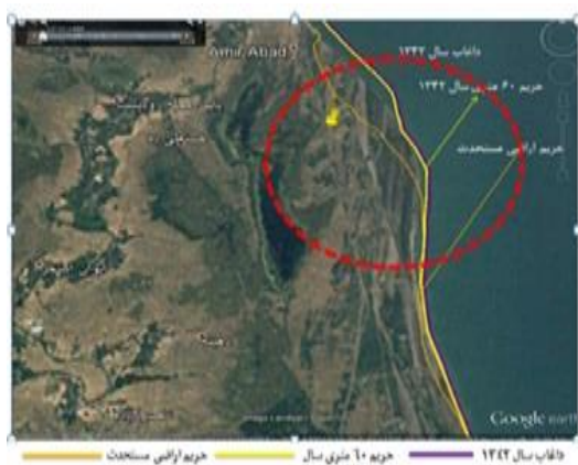
شکل (۸): موقعیت بخشی از سواحل امیرآباد نسبت به داغاب سال ۱۳۴۲ و حریم ۶۰ متری آن در تصاویر ماهواره‌ای سال ۱۹۸۴
